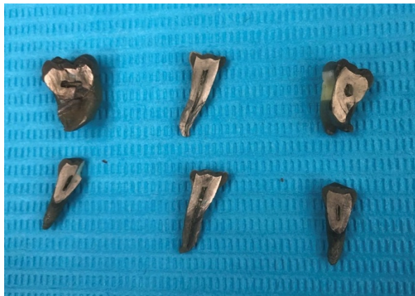
სურ. 2. ოქროს 10 ნმ. სისქის ფენით დაფარული საექსპერიმენტო ნიმუშები
