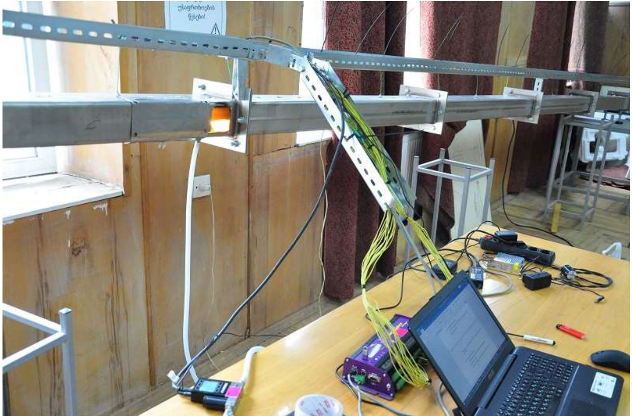
ფიგ. 1. სტუ-ს ექსპერიმენტული გვირაბის მოდელი მასთან მიერთებული გადამწოდებით და საზომი მოწყობილობებით.
