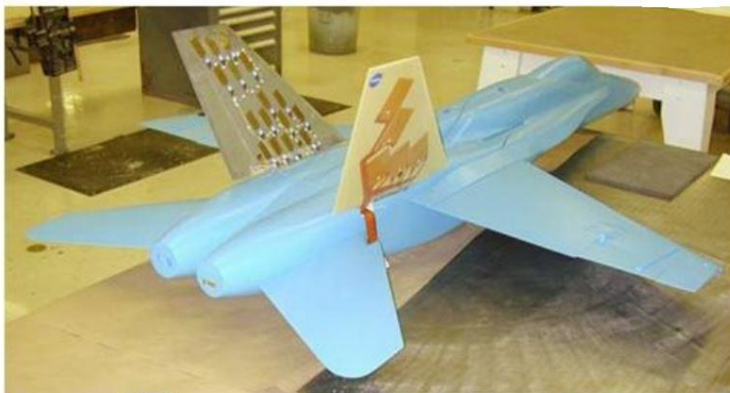
სურათი 3. ავიაგამანადგურებლის მოდელი მაკრობოჭკვიანი სენსორებითა და (MFC - Macro-Fiber Composite actuator) აქტუატორებით, თვითმფრინავის კუდის სტაბილიზატორებზე [ინფორმაციის წყარო: Mehrabian A.R., Yousefi-Koma A. A novel technique for optimal placement of piezoelectric actuators on smart structures // Journal of the Franklin Institute. 2011; Vol. 348.]
