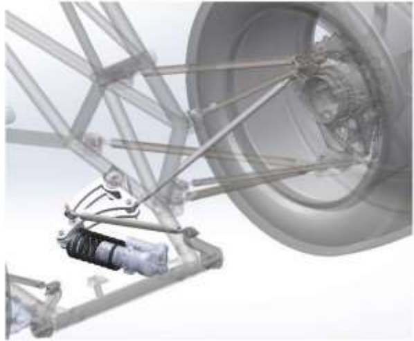
სურათი 2. მარჯვენა უკანა როკერის შეკრების ხედი. შემდეგი სურათი 3, გვიჩვენებს როკერის გეომეტრიას, რომელიც შექმნილია ტრადიციული მეთოდის მიხედვით.
