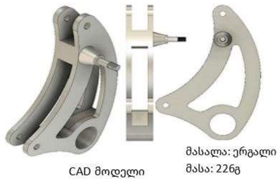
სურათი 3. როკერი შექმნილია ტრადიციული დიზაინის მიდგომით, რომელიც ორიენტირებულია ჩვეულებრივი წარმოების ტექნოლოგიაზე.
