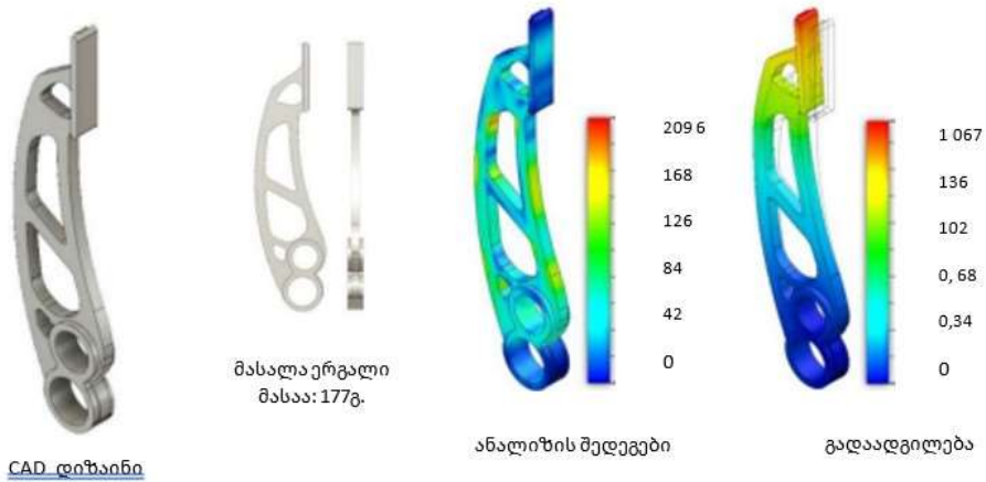
სურათი 13. გადაკეთებული სამუხრუჭე პედლები ერგალში, რომელიც დამოწმებულია FEM- ის ანალიზით
