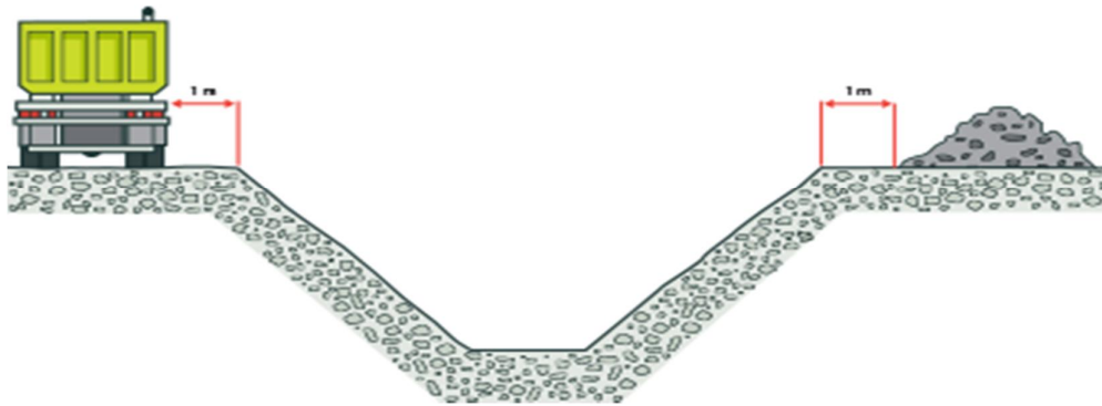
სურათი 1. მძიმე ტექნიკის დგომისა და ამოღებული ნიადაგის სწორად დაყრის ნიმუში.
