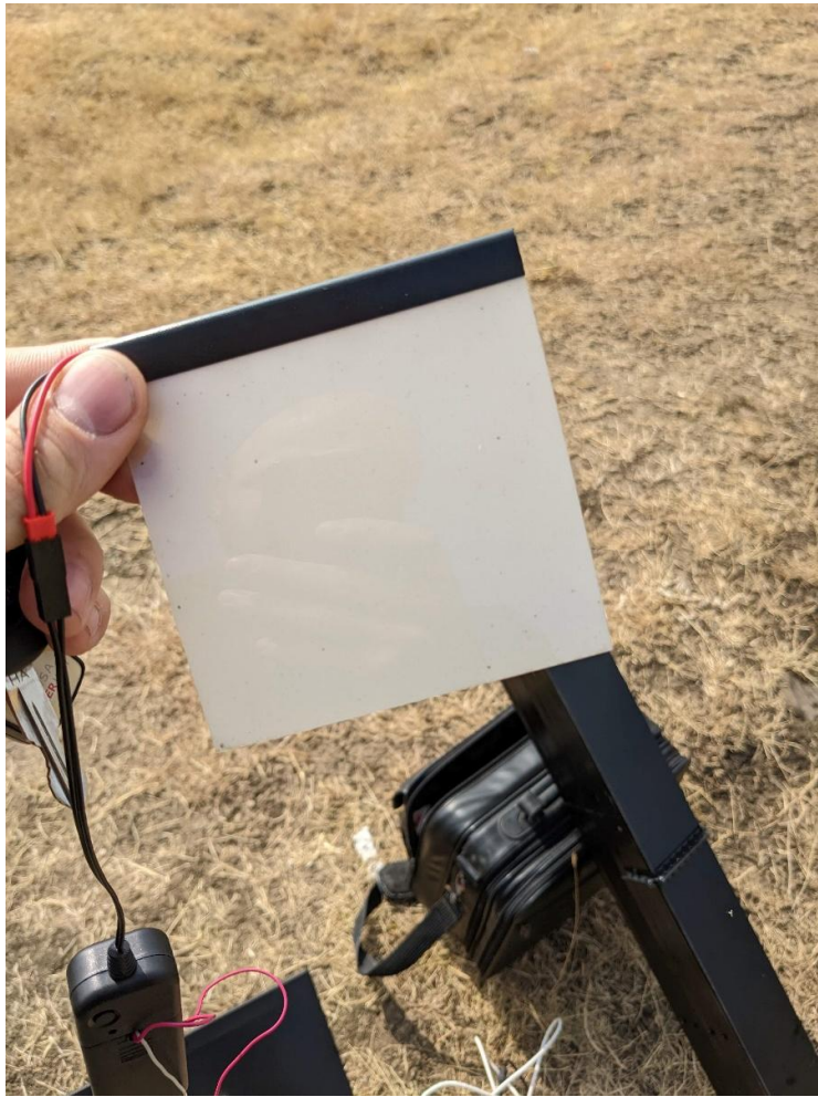
PDLC ფირი გათიშულ მდგომარეუბაში (დაბურული)
