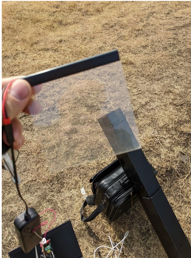
PDLC ფირი ჩართულ მდგომარეობაში (გამჭვირვალე)
