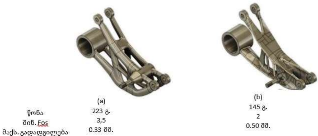
სურათი 17. ტიტანის როკერის დიზაინი, რომელიც მიღებულია (ა) და GD (B) ინსტრუმენტებით.
