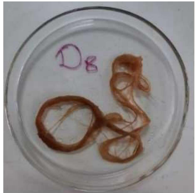
სურ. №3. ვერცხლის ნანონანილაკებით იმპრეგ- ნირებული იუკას ბოჭკოს ნიმუში
